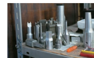
振動を増幅させ、溶着面により強い振動を加える共振体「超音波ホーン」
