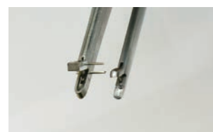
左が磨く前の鋭匙鉗子の先端。これを手作業で研磨し、右のように滑らかに。
