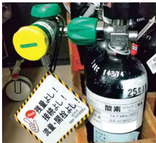
図表Ⅳ－２－２２ 酸素ポンベに使用可能時間早見表を設置した例
