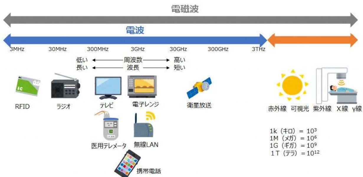
参-図1 電波と電磁波
