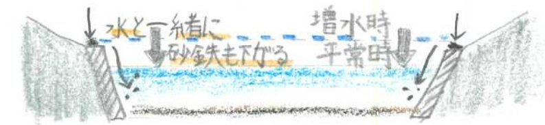
図5 砂鉄がたい積する仕組み
