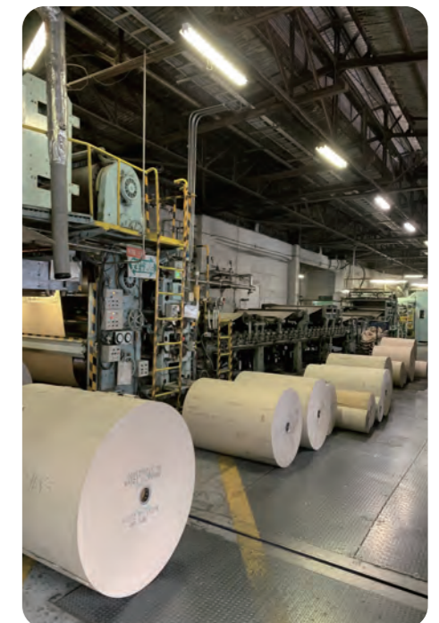
段ボール製作用コルゲートマシン
